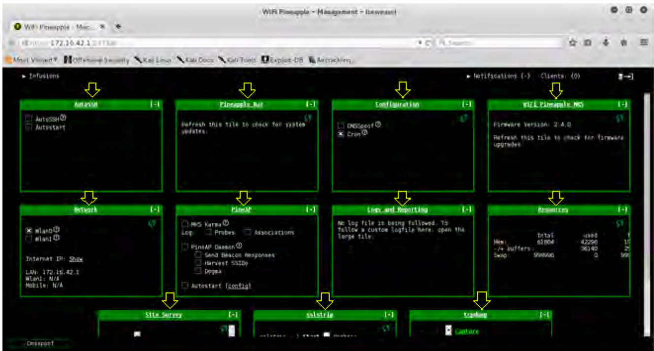
Ilustración 73: Portal con ventanas que hace referencia a diferentes herramientas y opciones de configuración integradas en el Wifi Pineapple Mark V.
